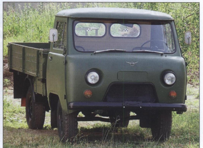
Вариант бортового грузовика УАЗ-452 с задним ведущим мостом
