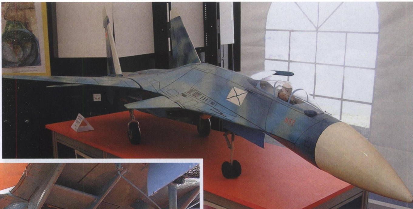
Радиоуправляемая модель истребителя Су-27. Поршневой двигатель с винтом удачно «спрятан» между мотогондолами и в полете совершенно не виден
