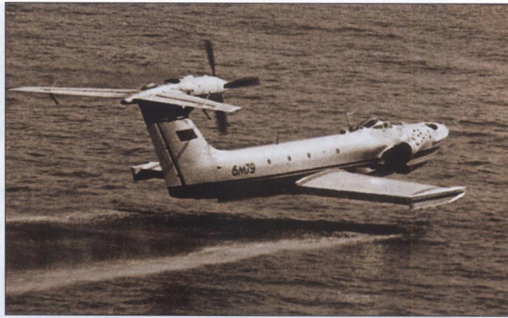
Опытный экраноплан СМ-6 – прототип экраноплана «Орленок»
