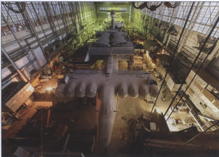
Незавершенный в производстве экраноплан «Спасатель»
