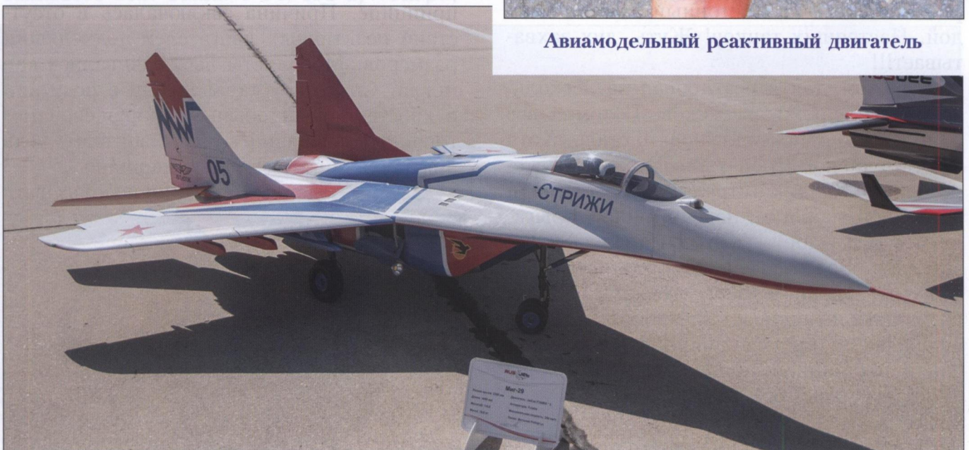
Радиоуправляемая модель истребителя МиГ-29 из пилотажной группы «Стрижи», оснащенная настоящими реактивными двигателями
