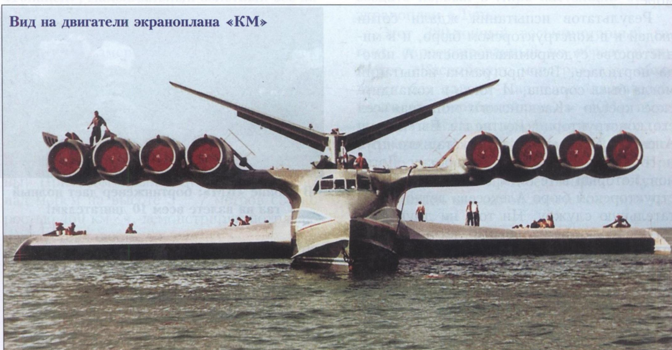
На этом снимке видно, что сопла левых двигателей отклонены во взлетное положение. Так обеспечивается поддув воздуха под крыло. Сопла правых двигателей находятся в положении для крейсерского полета
