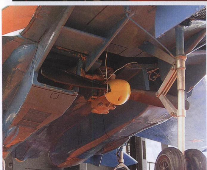
Радиоуправляемая модель истребителя Су-27. Поршневой двигатель с винтом удачно «спрятан» между мотогондолами и в полете совершенно не виден
