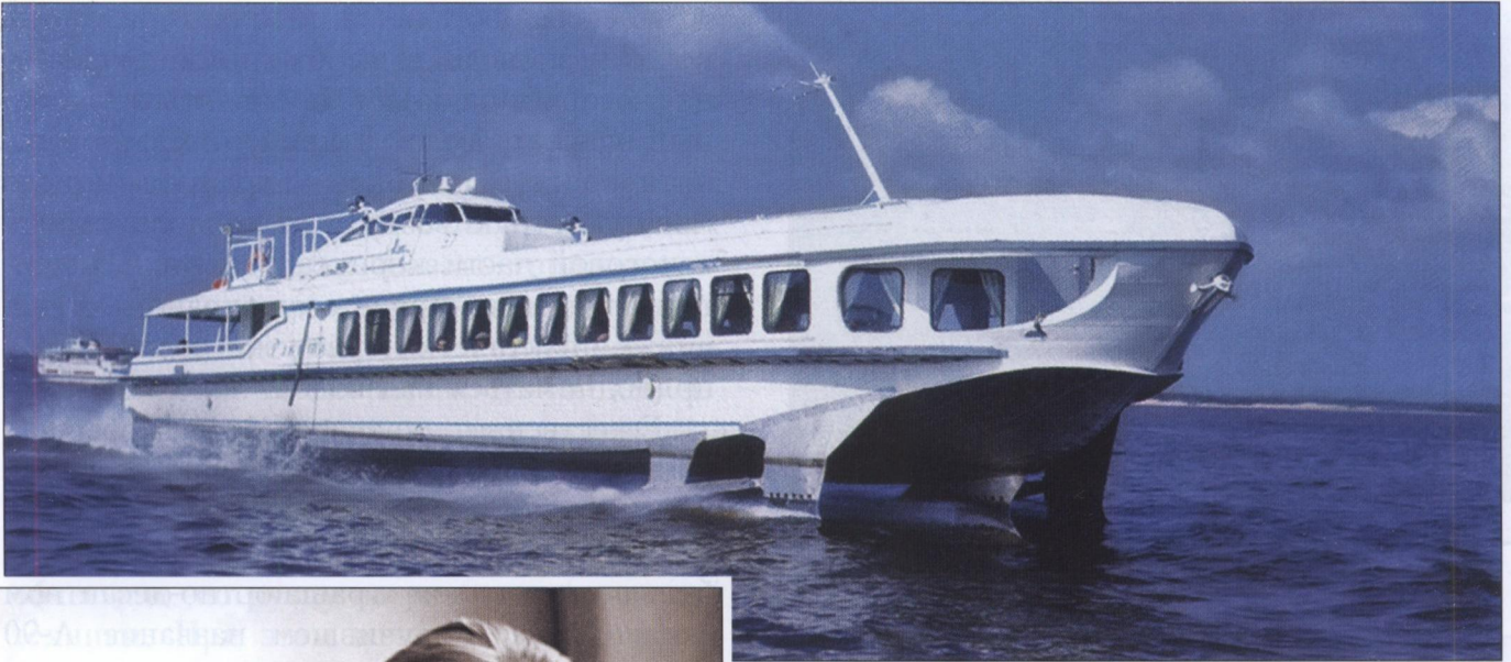
Судно на подводных крыльях «Ракета» конструкции Алексева – первое в мире, вышедшее на пассажирские линии
